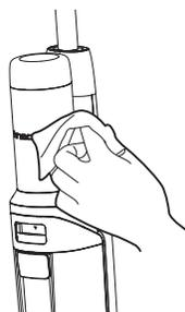
Pulire la superficie con un panno e un detergente neutro. Il panno deve essere asciutto per evitare che l'acqua penetri nell'apparecchio.
